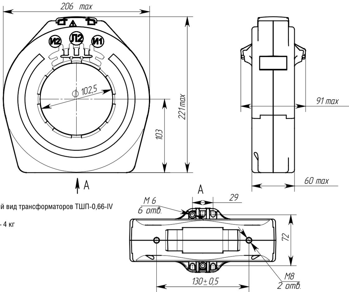
Рис. 1. Общий вид трансформаторов ТШП-0,66-IV
